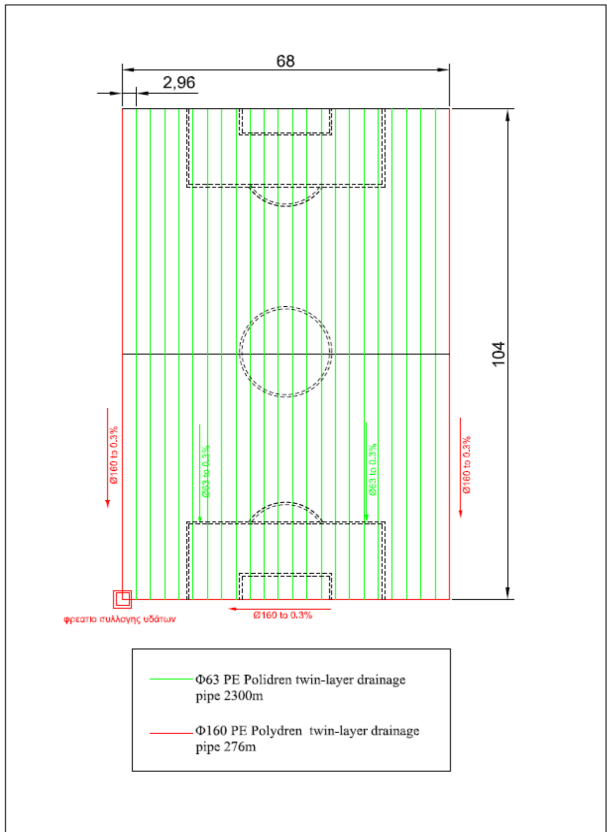
Εικ. 3 Ενδεικτική γενική διάταξη αποστραγγιστικού
